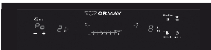
Fig. 17: Seleccionando un nuevo límite de potencia en un Equipo Smart Cook I4
